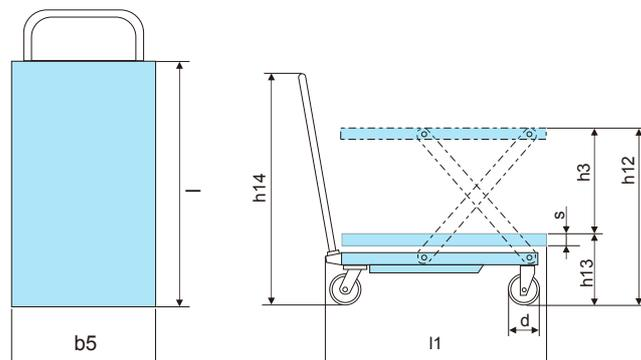
La table élévatrice SP800 est un outil de manutention idéal pour les différentes opérations de déplacement et de mise à niveau des marchandises, simple à utiliser et très maniable. Avec une capacité de déplacement et de levage des charges allant à 800 KG à une hauteur de 1000mm.
